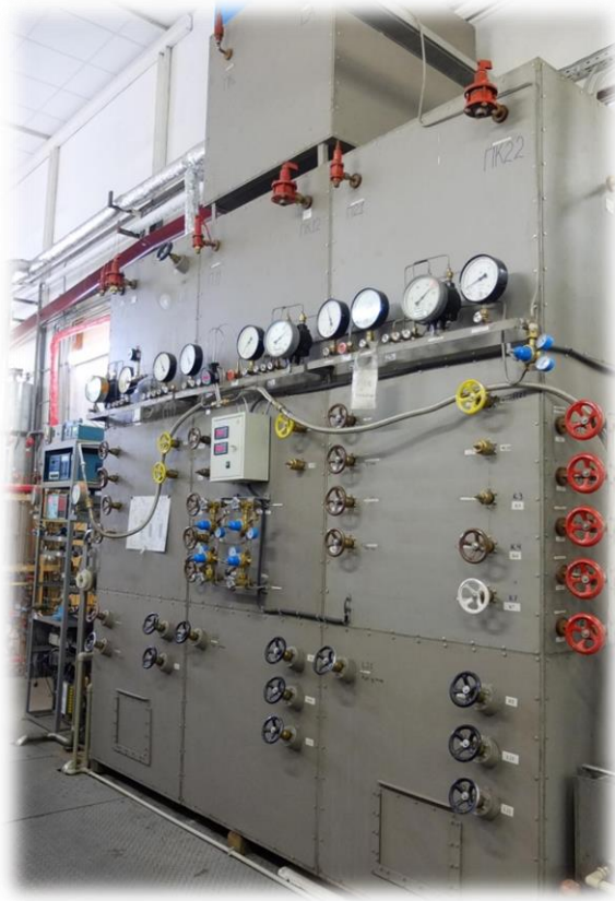
Рис. 18. Блок очищення установки для отримання неону
