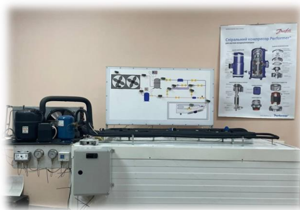
Рис. 20. Експериментальний стенд низькотемпературної камери у лабораторії дослідження холодильного обладнання
